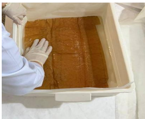
5. фото. Процесс смывания кислотности бумаги при реставрации
