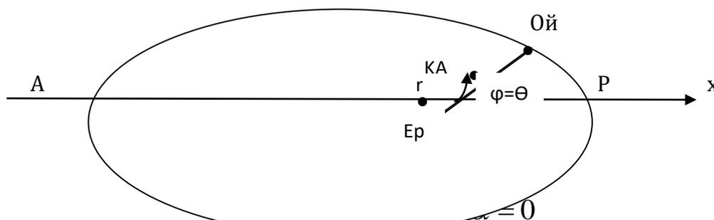
Если угол рассогласования  $\alpha = \pi$ ,  $\theta - \varphi = \pi$ , то КА отстаёт (или опережает) от Луны на угол  $\pi$  и находится на прямой, проходящей через центры Земли и Луны (рис. 3).  $\rho = r_1 + r$ . Угловые скорости КА и Луны совпадают.
