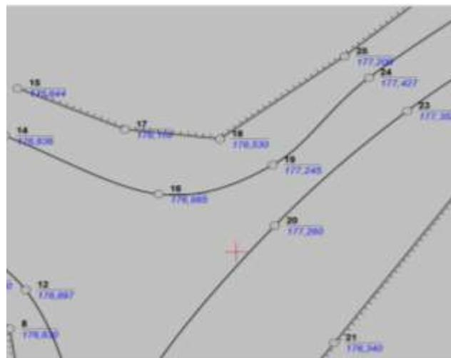
**Рисунок- 2. Пример полевого кодирования поперечника**
