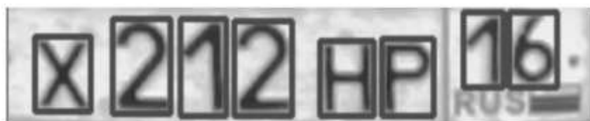
Рисунок-4. Результат сегментации символов автомобильного номера
