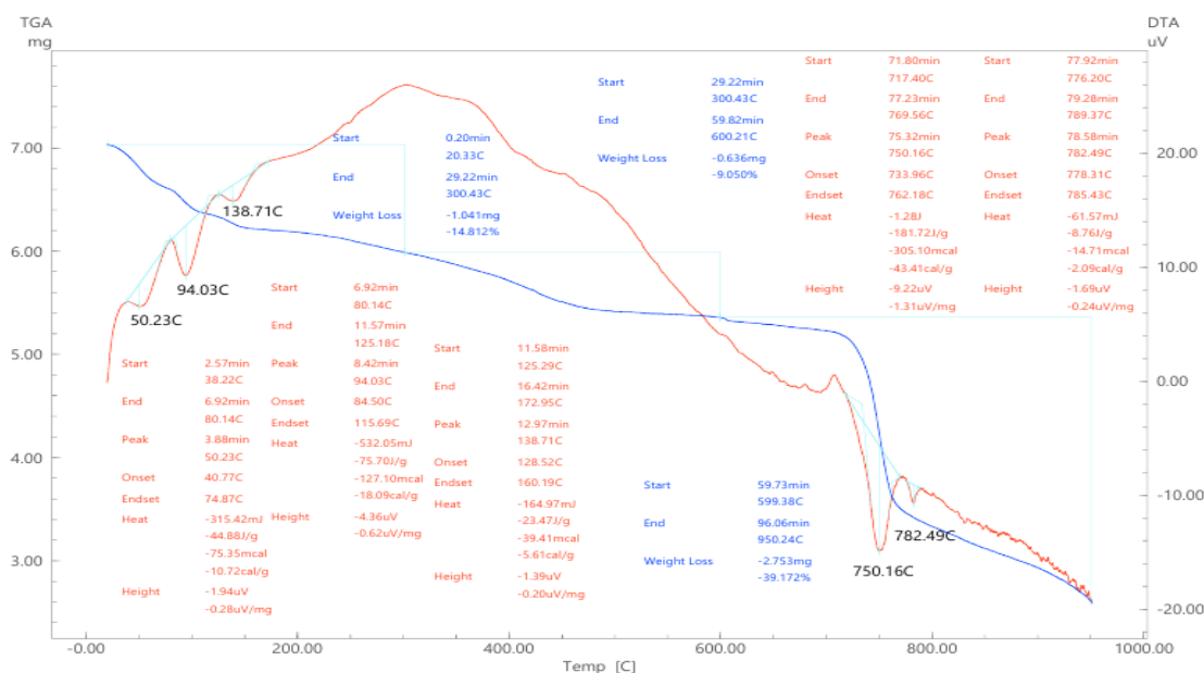
Рисунок 2. ДТА-анализ суперпластификатора, нейтрализованного NaOH.
