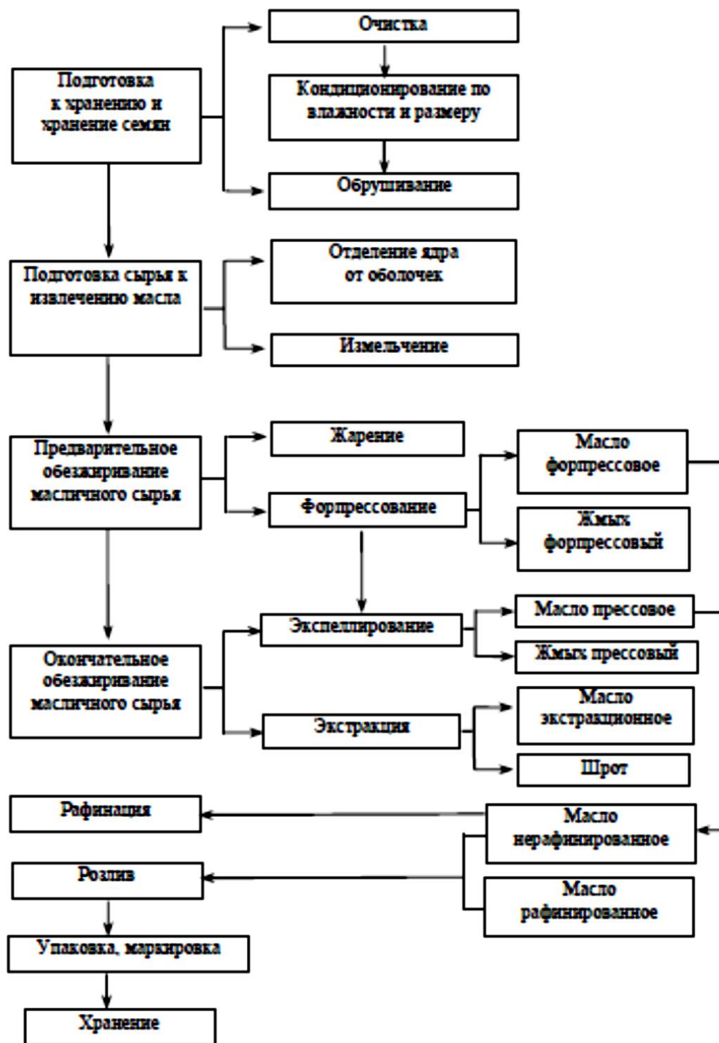
Рис. 1.1. Схема производства растительных масел
